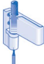
**Ein- und Aushängen der Tür bei einem Öffnungswinkel von ca. 90°. Falls erforderlich – Bolzen austreiben !**
