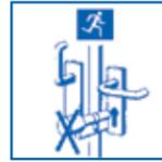
Bei Fluchttür-Systemen dürfen keine Schließzylinder mit Dreh-Knauf eingebaut werden.
