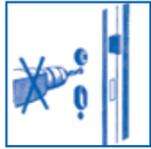
Der Türflügel darf im Schlossbereich nicht bei eingebautem Schloss durchbohrt werden.
